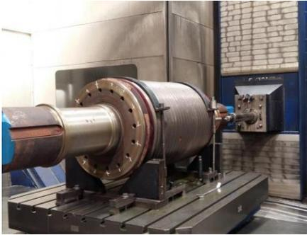
**Perforación radial con o sin eje**
